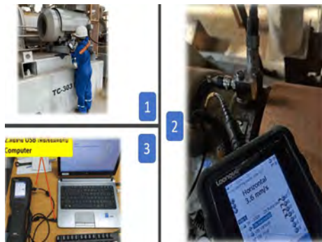
ภาพที่ 2.2-55x ระบบ Vibration Monitoring
